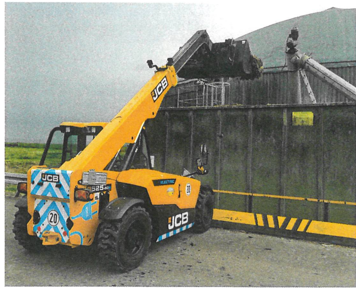
Ein Baustein zur Energiewende in der Landwirtschaft sind elektrische Landmaschinen, wie hier ein Teleskoplader, der mit selbst erzeugtem Strom angetrieben wird.
